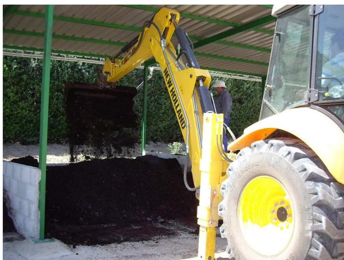
**Figura V.1** Detalle de los volteos realizados en la planta de compostaje.
