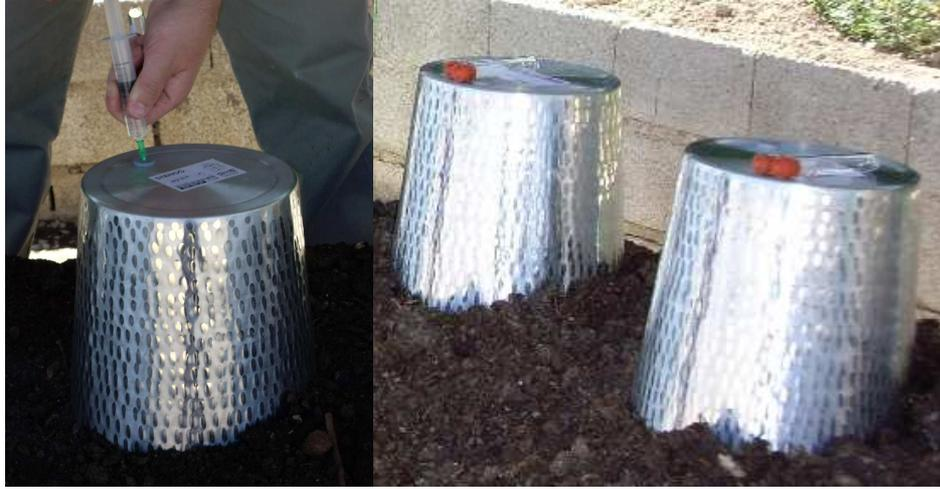
**Figura V.4** Toma de muestra. Se muestran los tubos (vacutainer®) donde se almacenan las muestras de gas.
