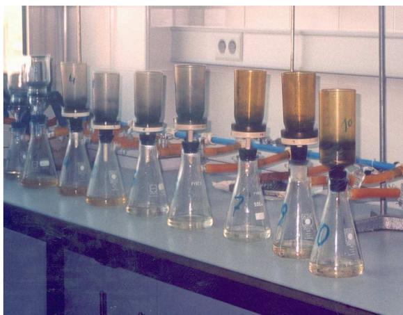
**Figura V.2.** Montaje diseñado para medir la CCC de los materiales orgánicos.
